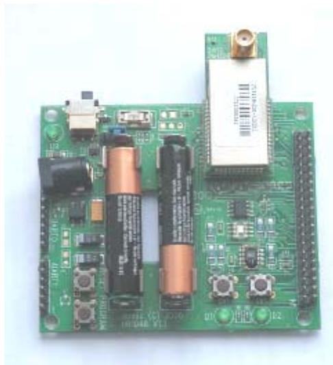
*ZigBee*-модуль на основе JN5139
