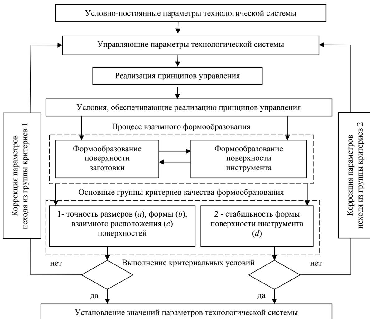
Рис. 1. Определение требуемых значений управляющих технологических параметров
